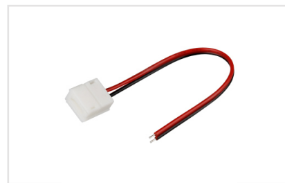
Артикул 022308 Одиночный коннектор с проводом 15см для подключения питания к ГЕРМЕТИЧНЫМ светодиодным одноцветным лентам шириной 8мм. Максимальный допустимый ток 3А, напряжение до 50 В.
