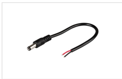
Артикул 022355 Круглый разъем DC 2-pin ПАПА для соединения отрезков одноцветных светодиодных лент. Провод 20AWG 15 см. Максимальный допустимый ток 3А. Ответный разъем МАМА поставляется отдельно.
