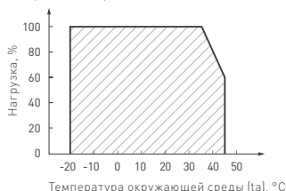
Рис. 5. Максимальная допустимая нагрузка, % от мощности источника
