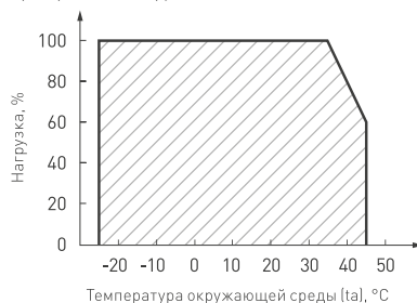
Рис. 3. Максимальная допустимая нагрузка, % от мощности источника
